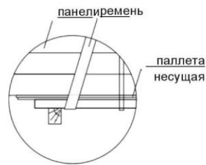
Деталь А (Схема подвешивания груза за деревянные паллеты)
