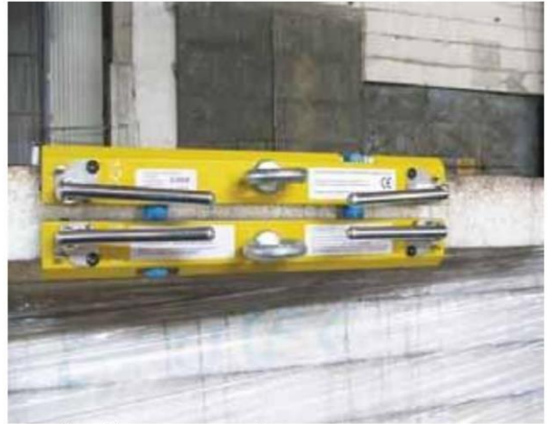
Рис. №19 Использование подъемного монтажного инструмента для сэндвич-панелей при размещении в вертикальном положении, длина \leq 6 м.
